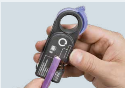
Зачистка и сборка с помощью M12 разъема
